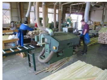
フィンガー科 大型の木工加工用機械を使い、集成材間柱の生産をしています。
